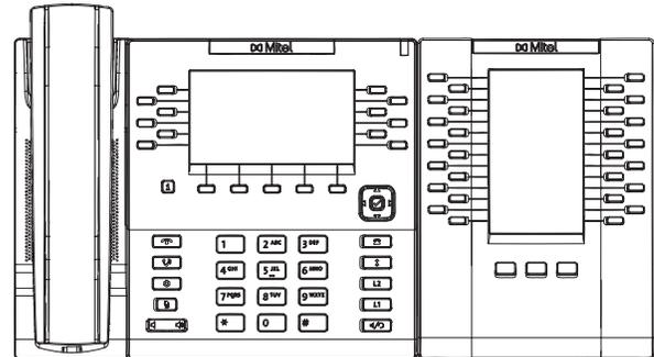
Das M680i umfasst 16 Softkeys, die jeweils eine LED zur Anzeige des Anrufstatus besitzen. Das M680i verfügt über einen Papiereinlegestreifen zur übersichtlichen Tastenbeschriftung.
