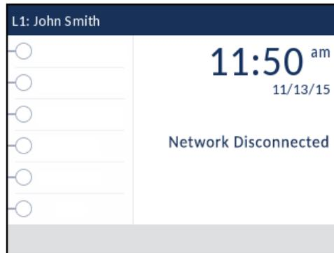
Überprüfen Sie, ob die Kabel am Telefon und an der Wandsteckdose fest angeschlossen sind. Wenn die Verbindung wieder hergestellt ist, stellt das Telefon dies automatisch fest und entfernt die Meldung **Net. getrennt**. Wenn die Einstellungen des Telefons geändert worden sind, muss das Telefon neu gestartet werden. Falls erforderlich, bitten Sie Ihren System- oder Netzwerkadministrator um Hilfestellung.
